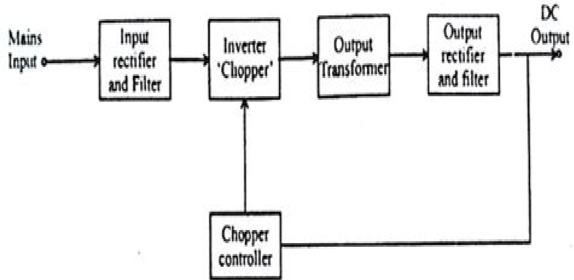
**fig.1 Block Diagram Of SMPS**
